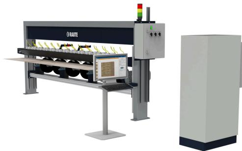
基于接触刷水分测量的单板水分分析仪，能够准确分析单板的水分，控制单板在胶合过程中的水分。
