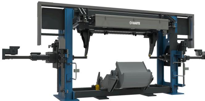
可用于新的旋切线或对现有生产线进行现代化改造的上木机。具有最高的激光扫描精度，可优化单板出材率和产能。
