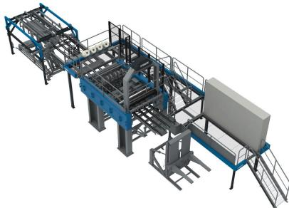
自动收集随机大小的单板的数据，并将其拼接成具有牢固接缝的完整板材，在干燥过程中不会断裂。检测仪最大限度提高绿色单板的出材率。
