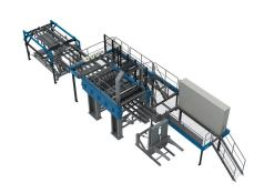
自动收集随机大小的单板的数据,并将其拼接成具有牢 固接缝的完整板材,在干燥过程中不会断裂。检测仪最 大限度提高绿色单板的出材率。
